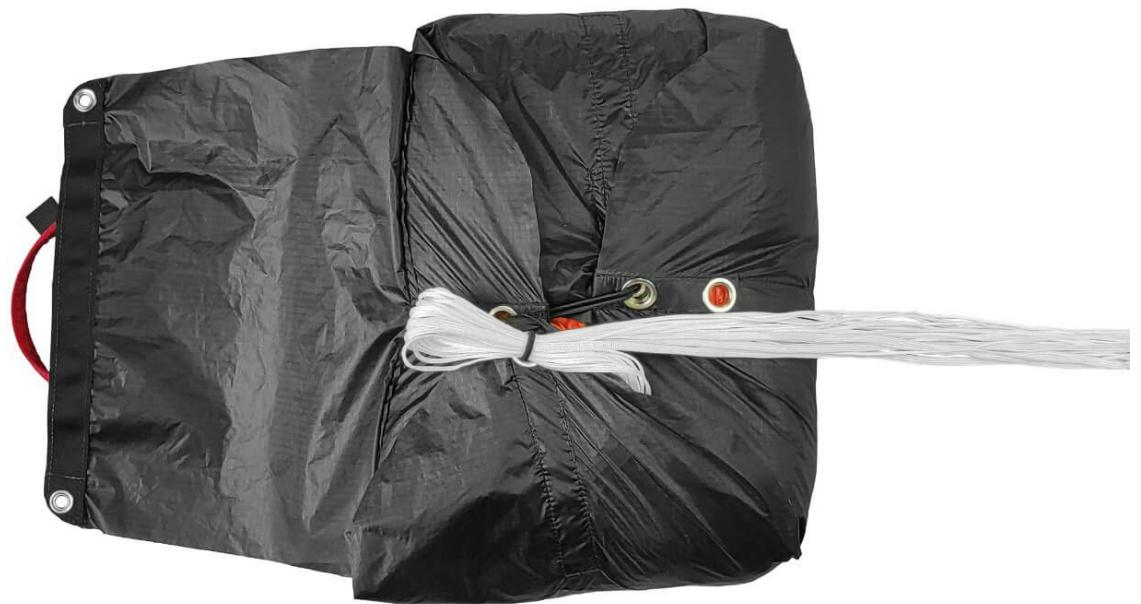
Chiudi l'ultima patta del contenitore con due anelli di linea di uguale lunghezza (5–6 cm). Questi ultimi anelli sono tenuti da due elastici che passano attraverso gli occhielli della patta esterna del contenitore. I due elastici sono preassemblati in fabbrica.
